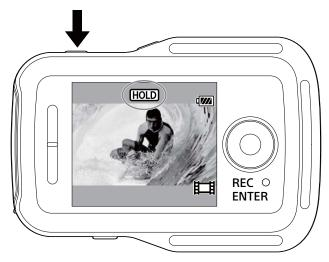
En mode de blocage des boutons, HOLD s'affiche sur l'écran de cet appareil. Les touches REC/ENTER, DISP, UP et DOWN de cet appareil sont désactivées.
